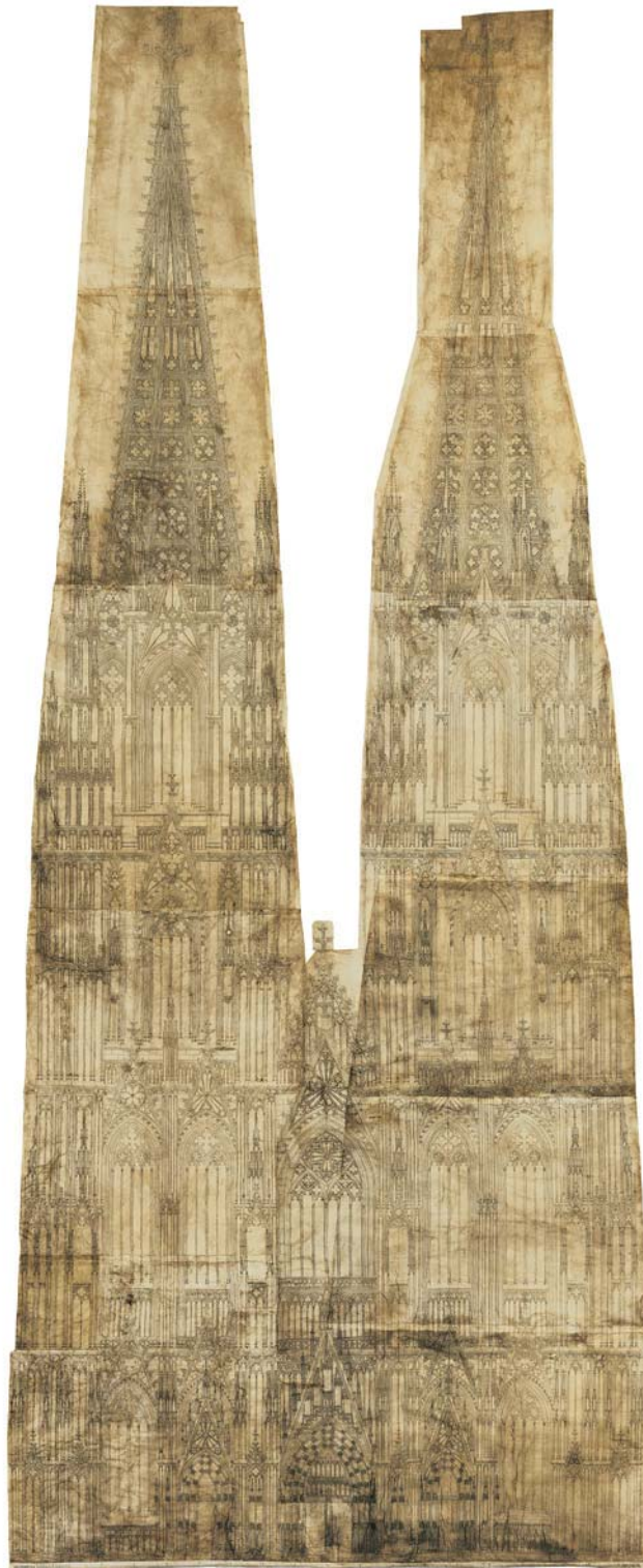
Abb. 208: Köln, Dom, Fassadenriss F. Gesamtansicht Pergament – Höhe 405 cm – um 1300 Hohe Domkirche zu Köln, Dombauhütte Köln
