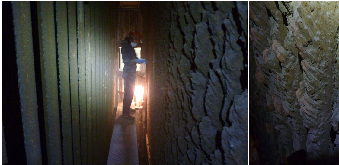
Figure 7.2: Probenahme im Kessel zwischen Überhitzer 1 und 2, Rauchgasrichtung nach links. Die Wächten haben sich gegen die Rauchgasrichtung ausgebildet.
