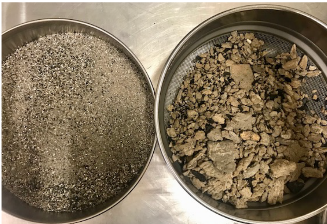
Figure 7.4: Durch ein 2mm Sieb lässt sich die Kesselasche grob unterteilen in rieselfähiges Material (links) und Krusten (rechts), die sich an den Wärmetauscheroberflächen gebildet haben (rechts).
