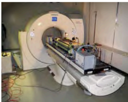
De sandbox-machine in de röntgenscanner gedurende een experiment.
